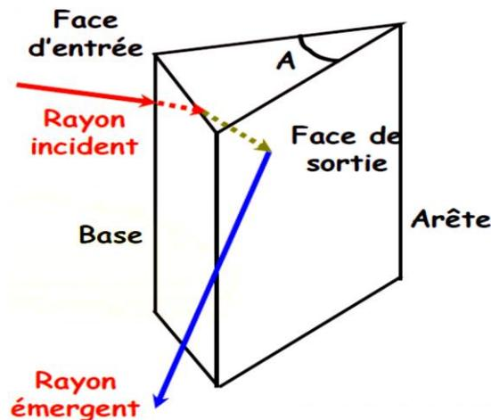
En général, le prisme est plongé dans l'air. Le prisme est utilisé soit pour changer le sens ou la direction de propagation d'un rayon lumineux à la suite de réfractions ou de réflexions, soit pour analyser une lumière polychromatique grâce à ses propriétés dispersives.
